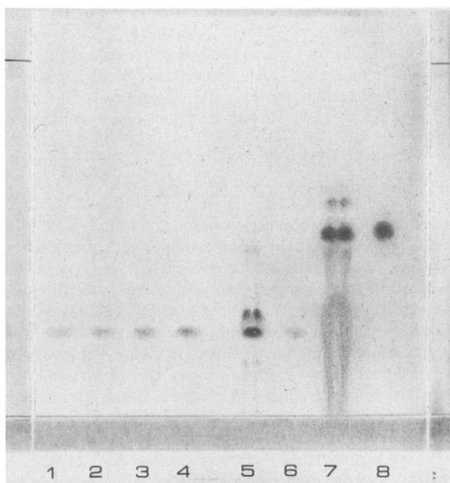
Fig. 2. Chromatographie des solutions essais et estimation de la migration du composé III. Plaque à zone de concentration; dépôts: 100  $\mu$ l (sauf composé I: 2  $\mu$ l); solvant (b); révélation par le réactif  $R_1$ . 1, 2, 3 et 4 = composé III, en solution à 2,5, 5, 7,5 et 10 mg pour 100 ml, respectivement; 5 et 6 = seringues stérilisées par l'oxyde d'éthylène, essais B et A, respectivement; 7 = seringues stérilisées par irradiation, essai B; 8 = composé I en solution à 0,5% (m/v).
